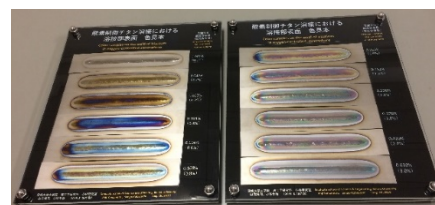
図：シールドガス中の酸素含有量を制御し，適切にチタン表面のみを酸化させた溶接部の色見本
